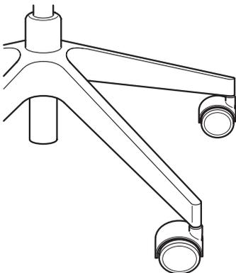
当你离开椅子时，椅子应停留在原地，而不会自行滑动，因此我们在椅子上安装了安全脚轮。脚轮带有内置压力感应制动装置，你坐在椅子上时可以轻松自由地滑动，但当你起身后，就会启动轮刹。请注意，尽管脚轮刹住后椅子不会自行滑动，但如果有人推动，它们仍可在地板上滑行。
