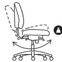
**自动倾斜松紧度**；靠背将根据你的体重提供支撑力。
